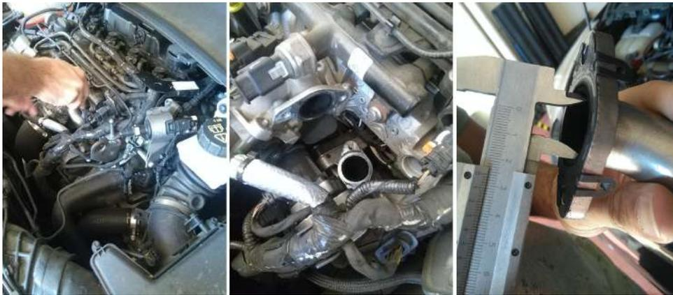
**Desmontaje de elementos del escape, medición del diámetro del conducto**
