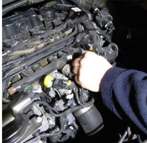
**Desmontaje de elementos del escape**
